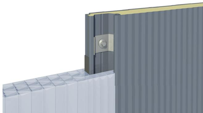
DETALLE ENTREGA ENTRE PLACAS DE POLICARBONATO - PANEL METÁLICO
